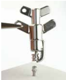
Entfernte Hülse im Hülsenextraktor
