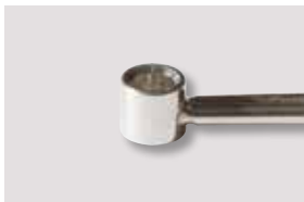
Draht auf Stoß angelasert
